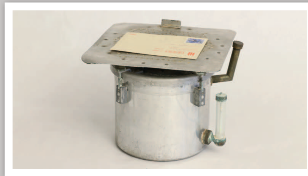
Levélbontó, a gőzöléses levélfelbontáshoz használt eszköz (ÁBTL); fotó: Várai Mihály
